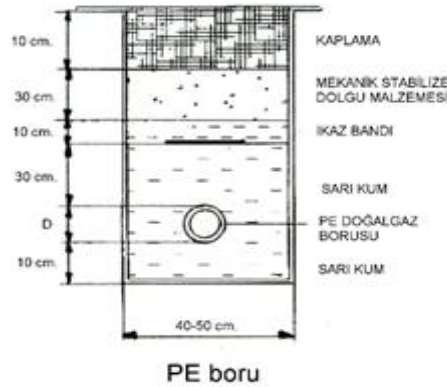
Şekil–17 Polietilen Borulara Ait Tranşe Detayı
